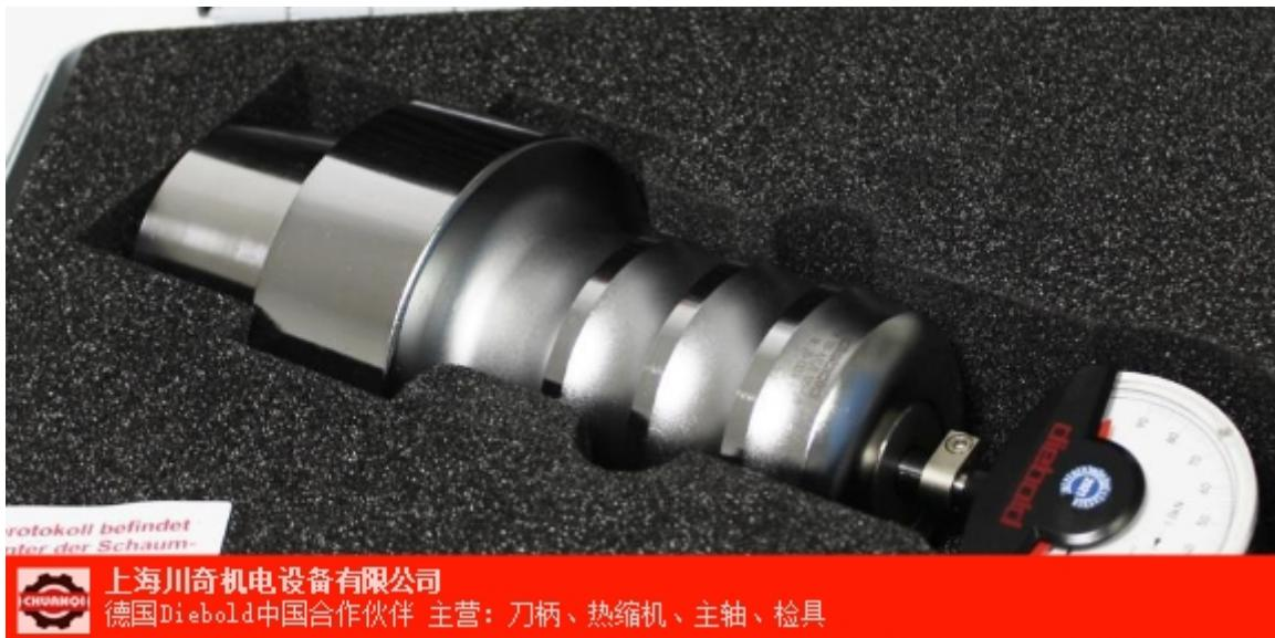
德国Diebold主轴拉力计内部结构为钢部件，因此不受环境温度影响，而电子式拉力计如果想要准确的测量结果，在使用之前必须调温，这意味着需要几小时的等待，维修工程师们没有这么多在客户车间等待维修的时间。Diebold主轴拉力计可以随时随地可靠的进行测量，这就是它们如此受欢迎的原因。
